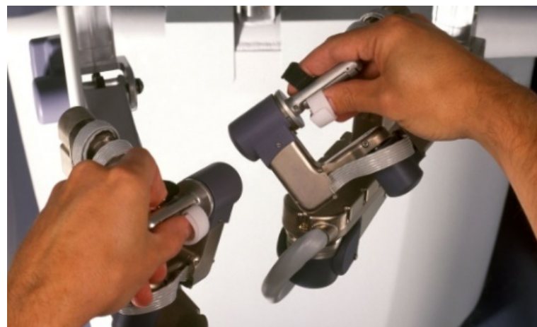
Figura 1 - Corrispondenza dei movimenti eseguiti sui controlli della console chirurgica con i movimenti effettuati all'interno del corpo umano dalle braccia robotiche.
